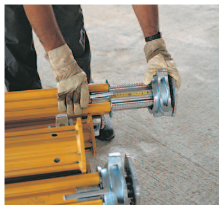
Kõikidel MULTIPROP postidel on sisseehitatud mõõtelint.
